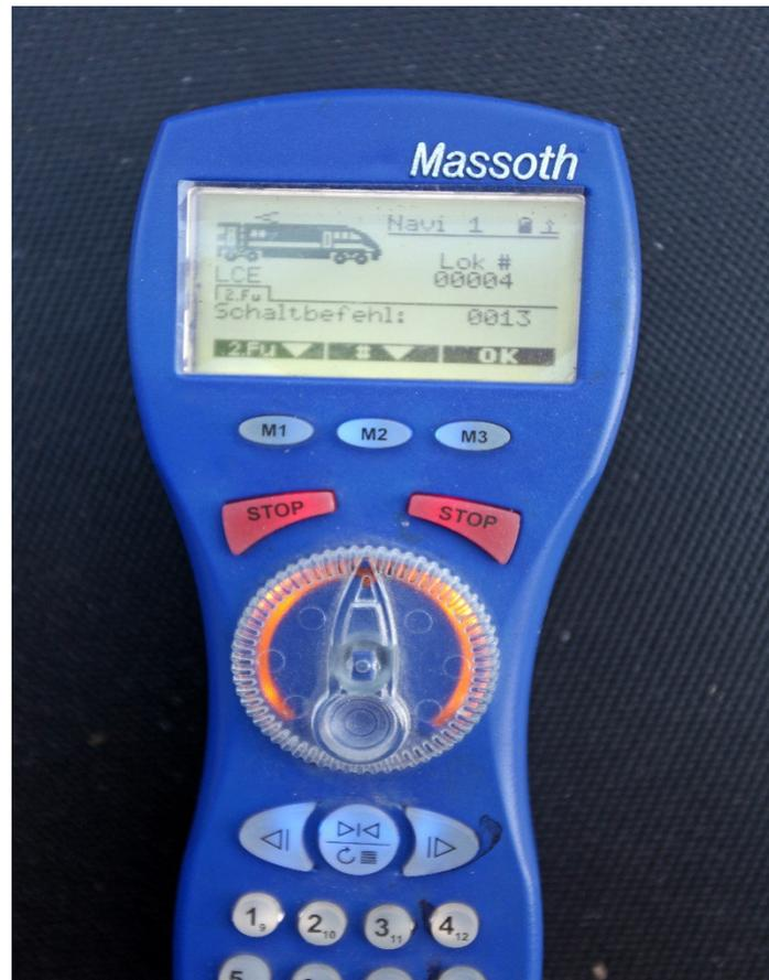
Anschließend wählt man eine der Pfeiltasten unterhalb des Drehreglers aus und drückt diese. Damit ist die erste Signalfarbe programmiert. Nun fängt die nächste LED an zu blinken und man wiederholt das Ganze. Natürlich nimmt man die andere Pfeiltaste. Hat man noch ein weiteres Signal angeschlossen, blinkt dessen LED. Man sucht eine beliebige Adresse aus, drückt eine Pfeiltaste usw.
